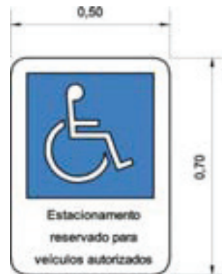
Sinalização vertical em espaço interno
